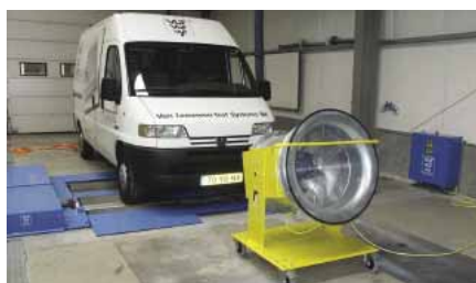
Van on VLT 248950 with cooling fan
